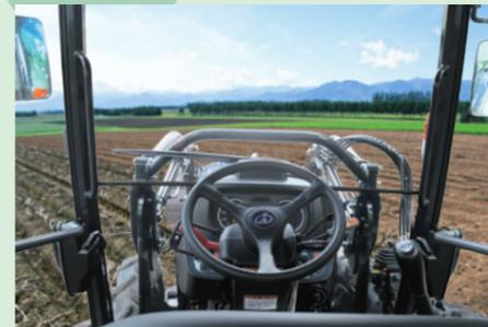
トラクタの中央部のみでローダを支持するミッドマウント方式です。サイドフレームがなく、運転席からの作業視界が広く、土砂・堆肥の持ち上げ、ダンプが効率よく安全に行えます。
