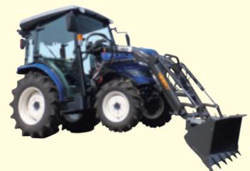
リフトシリンダは複動・フローティングワンタッチで切替え。軽土木・積荷の加圧・ぬかるみからの脱出などは複動で、集草・整地(除雪)など圃場の凹凸に沿った作業はフローティングで、オールラウンドな作業ができます。
