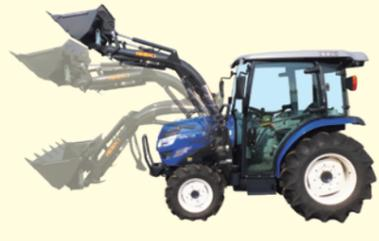
先端アタッチメントを常に平行に保ちながら平行昇降が可能です。パレット作業や、バケットでのスクイ作業で荷こぼれなく、精度の高い作業が容易に行えます。
