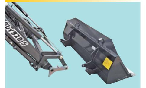
スナップヒッチの採用により、先端アタッチメントの交換が簡単に行えます。
