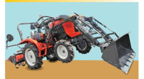
複動油圧なので、掘削・積荷押さえ込み・ぬかみ脱出等、バケットを地面に押さえつけての作業が可能です。また、複動とフローティングの切り換えが、トラクタに乗ったまま容易に行えます。
