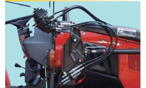
エンジンを停止させると油圧回路が自動的に遮断される「ノンリークバルブ」を採用。万が一ローダを上げたままエンジンを止めても、リフトアームが下降することなく安心です。
