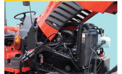
作業時の視界の向上とともに、トラクタのメンテナンス性が向上するサイドフレームレス構造を採用しています。
