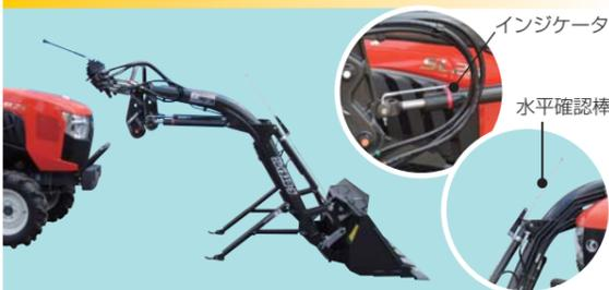
「インジケータ」を所定の位置に合わせることで、離脱姿勢が運転席に座ったまま確認できます。さらにエンジン停止状態で、バケットを水平に離脱させる新離脱構造を採用。残圧を抜くだけで簡単に離脱できます。
