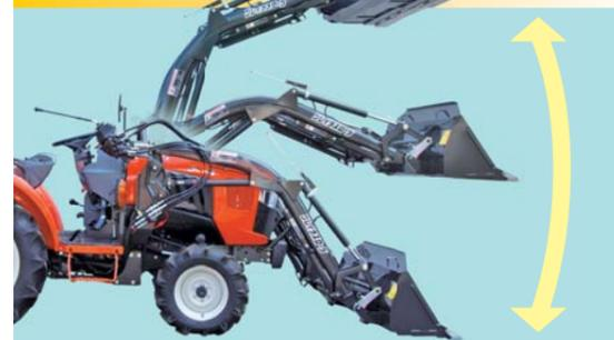
先端アタッチメントを常に水平に保ちながら平行昇降でき、土砂や堆肥等、荷こぼれの少ない安定した作業ができます。
