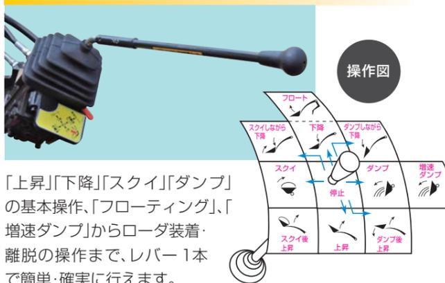
「上昇」「下降」「スクイ」「ダンブ」の基本操作、「フローティング」、「増速ダンブ」からローダ装着・離脱の操作まで、レバー1本で簡単・確実に行えます。
