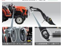
グレイタスJrで必要となる、ドッキングキット(オプション) による手動着脱作業をよりスムーズに。離脱時に生じるズレ を考慮した新着脱構造を採用し、容易にピンの挿入が可能 に。作業準備の時間短縮を実現します。
