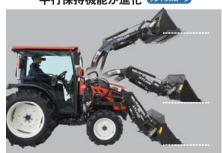
ローダの上昇・下降操作時における平行保持(水平維持)の精度が 向上。作動油の不足が発生した際にタンク回路から作動油を供給す る弁を追加し、スクイ方向へのズレを軽減。さらに精密な並行保持を 実現し、パレットフォークによる作業等もより安定して行えます。
