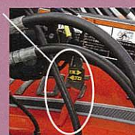
油圧操作レバー 左右に動かして残圧を抜く
