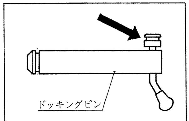
5 残圧抜き器（ドッキングピン付属）
