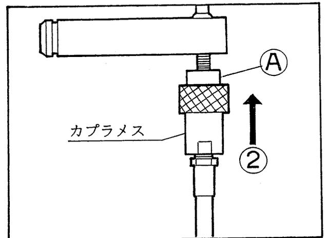
(3) カプラメスを片手で持ちながらドッキングレバー (C) またはドッキングピン (D) を締める方向（右方向）に回す。
