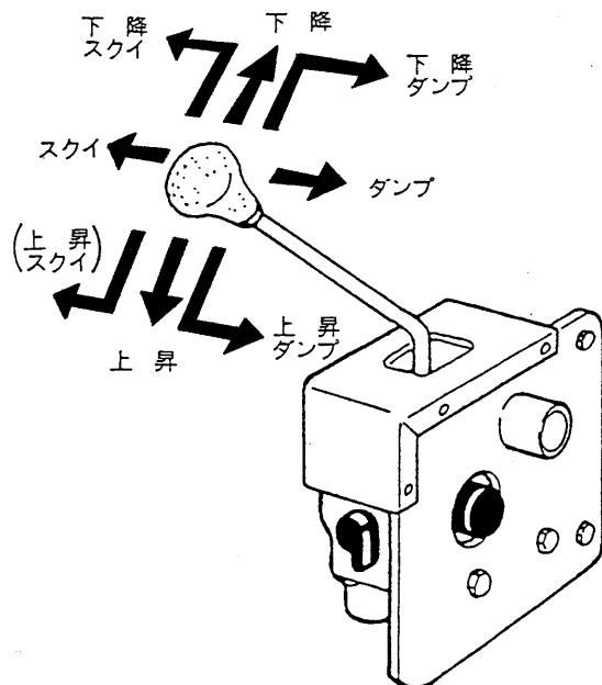
(注) 「上昇しながらスクイ」のポジションは、規制プレートにより使えないようになっています。ローダ作業に慣れた時点でこのプレートを取りはずし、作業していただいても結構です。
