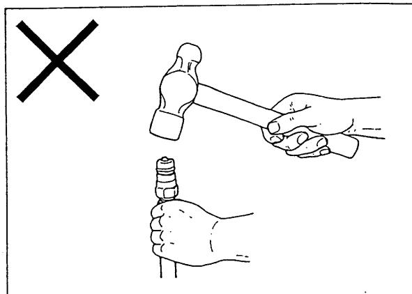
カプラの先端部を傷つけると、油もれや接続不良などを起こし、カプラを破損させる原因となります。残圧のためカプラが結合できない場合は、ホースとカプラのネジ結合部をゆるめて油を少し抜き、再び締め込んでください。（右図）
