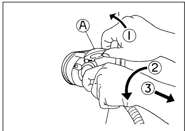
**注意** 凹凸のはめ合い部 Ⓐ がずれたままトレーラコンセントを無理に押し込むと、オス側先端部 Ⓑ が陥没し、コンセントが接続できなくなります。
