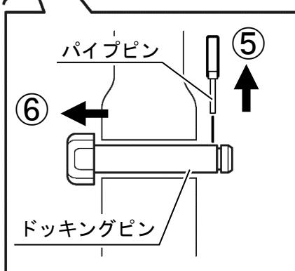
⑥ 左右のドッキングピンを抜き取る。(2箇所)
