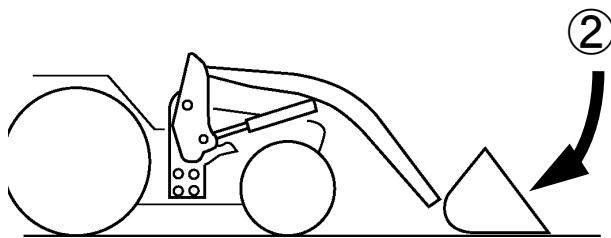
② 先端アタッチメント底面を接地させる。
