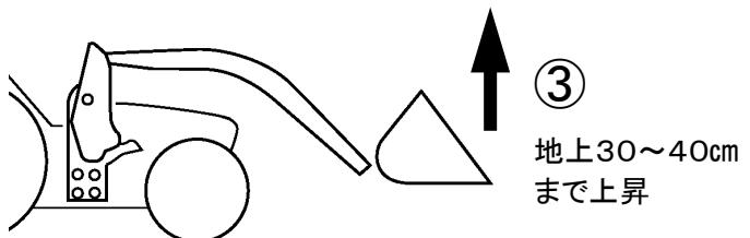
③ 操作レバーを「上昇」にし、先端アタッチメント底面を地上30~40cm浮かせる。
