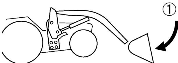
② 左右のドッキングピンが軽く回れば操作停止する。
