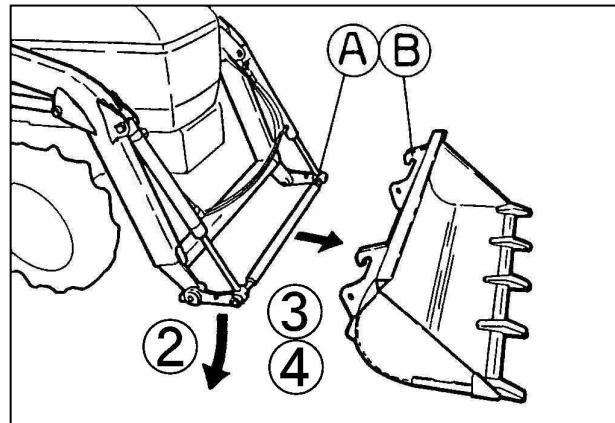
② 1本レバーを「ダンプ」にしてスナップヒッチを前傾させる。
