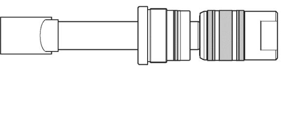
(5) ピストン側面にある止めネジを取りはずす。
