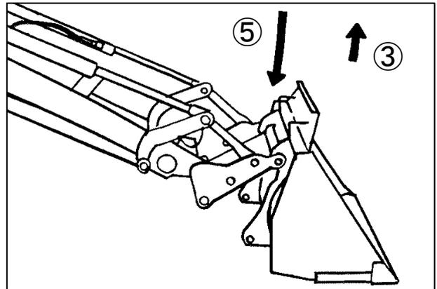
⑤ 操作レバーを「ダンプ」にしてスナップヒッチ先端①でアタッチメントのフック部②を引っ掛けた状態にする。
