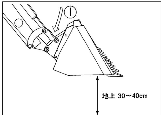
操作レバーを「ダンプ」にして、スナップヒッチを垂直から 45 ° 前傾状態にする。
