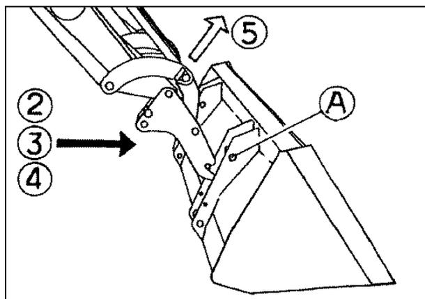
スナップヒッチ先端をアタッチメントの取付部に引っ掛け、操作レバーを「上昇」にしてアタッチメントを地面から離す。
