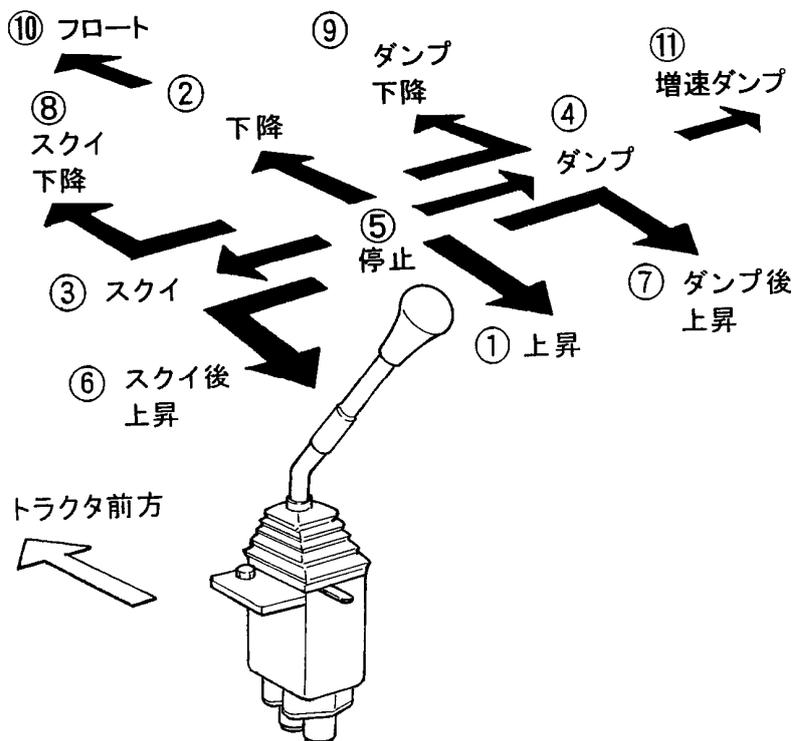
**注意** 右図中、複合操作の位置（⑥⑦⑧⑨）は、機構的には直接（斜め方向に）操作レバーを入れることができます。ローダ操作に慣れた時点でお使いください。
