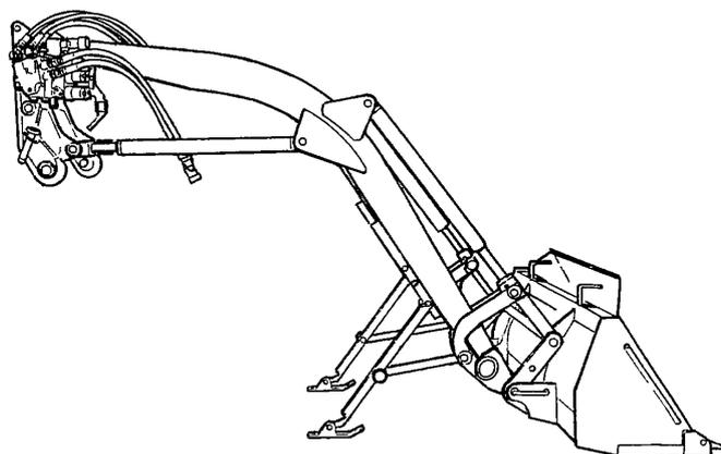
▲ 上図は電磁弁式ローダの場合
