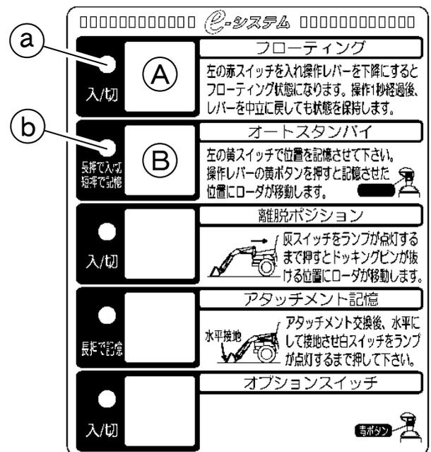
**注意** オートスタンバイが作動している途中で操作レバーを操作すると、操作レバーの操作が優先されます。
