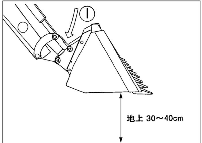
④ 操作レバーを「ダンプ」にして、スナップヒッチを垂直から 45° 前傾状態にする。
