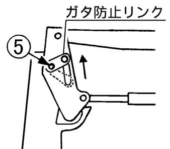
**注意** ピンが抜けられない場合、トラクタのエンジンをかけ、微少にスクイ・ダンブ操作を行い、ピンを抜いてください。
