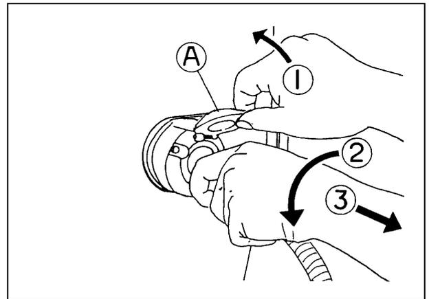
**注意** 凹凸のはめ合い部 ③ がずれたままトレーラコンセントを無理に押し込むと、オス側先端部 ④ が陥没し、コンセントが接続できなくなります。
