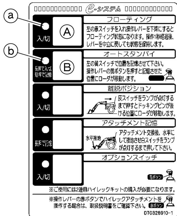
**注意** オートスタンバイが作動している途中で操作レバーを操作すると、操作レバーの操作が優先されます。
