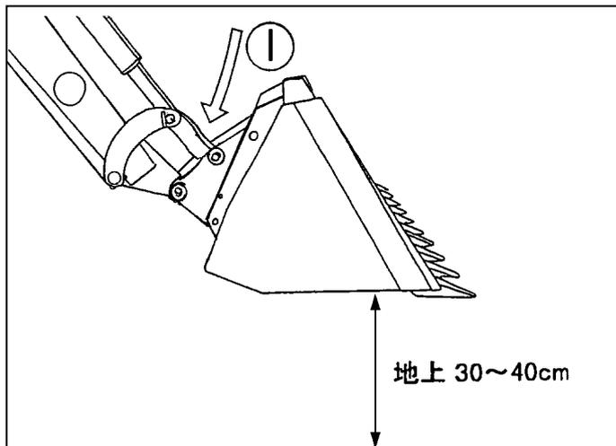
操作レバーを「ダンプ」にして、スナッチヒッチを垂直から 45 ° 前傾状態にする。
