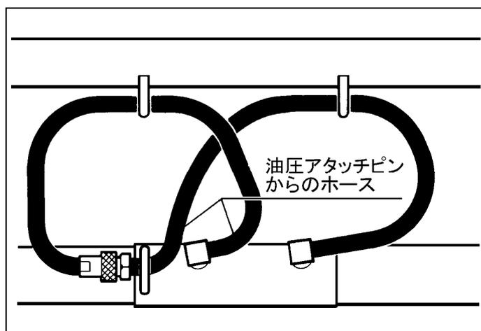
2 連目ハイレックキットを追加して、ボタン ㊸ でロールグラブを作動、ボタン ㊹ で油圧アタッチ(ピン)を作動させる場合
