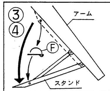
⑥ 操作レバーを「上昇」にし、フレーム上部を10~15cm前傾させる。
