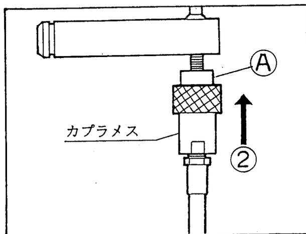
**注意** 右図のようにカプラホルダ (A) をドッキングピン (D) 側に移動させた状態でカプラメスをセットしないでください。カプラメスからの油の流出が止まらなくなることがあります。
