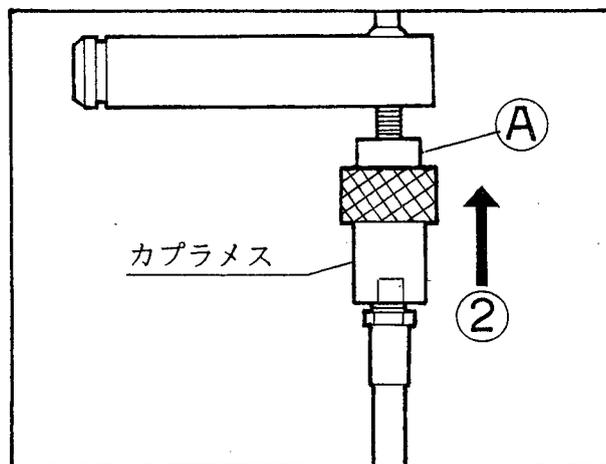
(3) カプラメスを片手で持ちながらドッキングレバー (C) 又はドッキングピン (D) を締める方向（右方向）にまわす。
