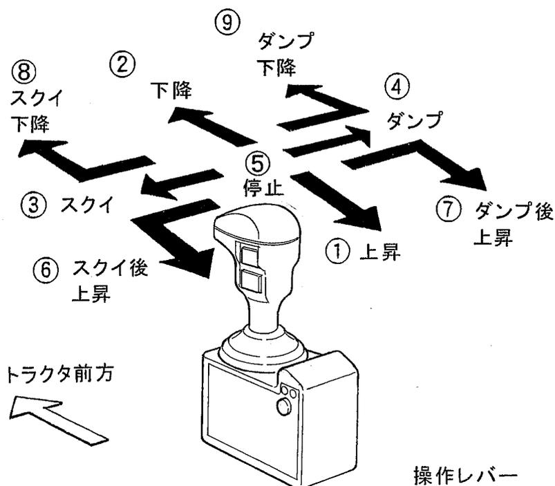
**注意** 右図中、複合操作の位置（⑥⑦⑧⑨）は、機構的には直接（斜め方向に）操作レバーを入れることができます。ローダ操作に慣れた時点でお使いください。
