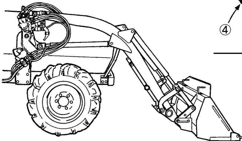
▲ 上図は電磁弁式ローダの場合
